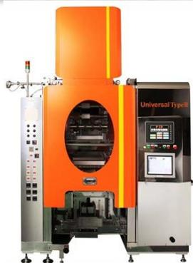
製品名：容量可変液体充填包装機
